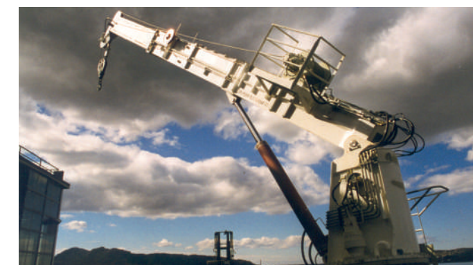
Судовой стреловой кран, совместное производство «Dreggen»
