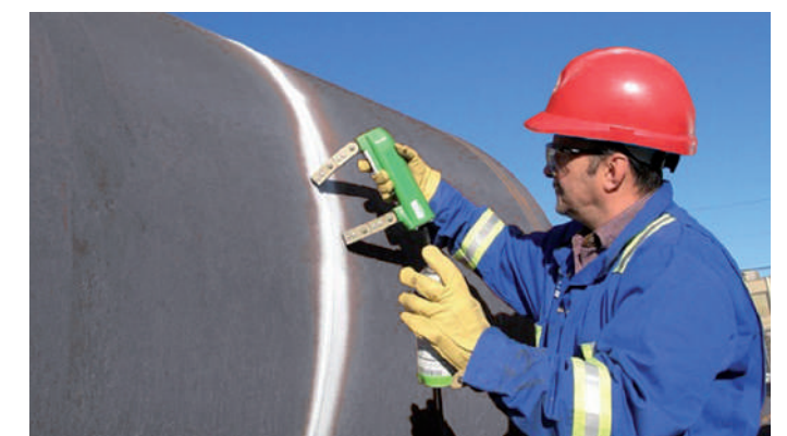
Неразрушающий контроль сварных швов и материалов
