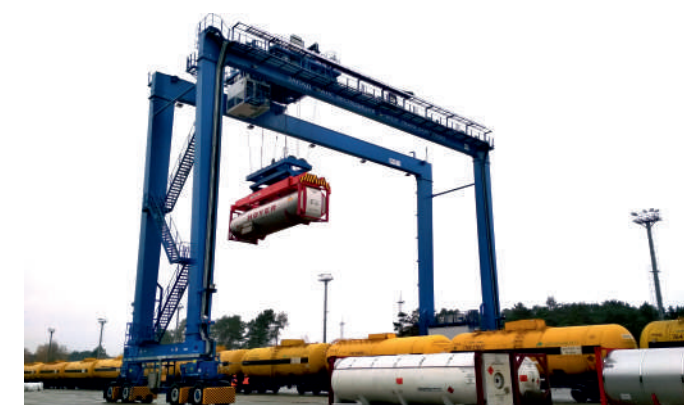
"ЗападТрансЭкспедиция", г. Брест, кран RTG г/п 36 т., пролет 7+1, высота штабелирования 5+1
