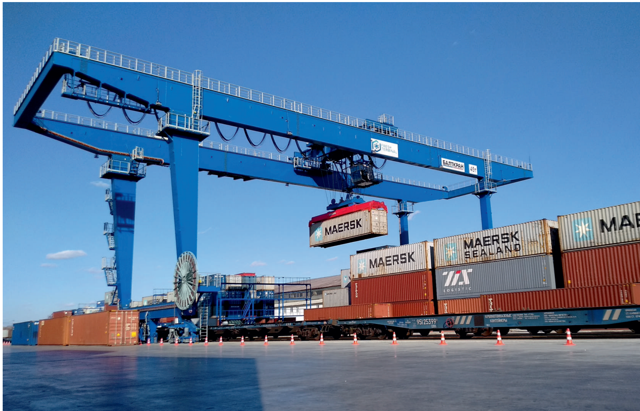
«FRESH TERMINAL», г. Артём, RMG кран, г/п 45 т., пролет 40 м. высота 4+1
