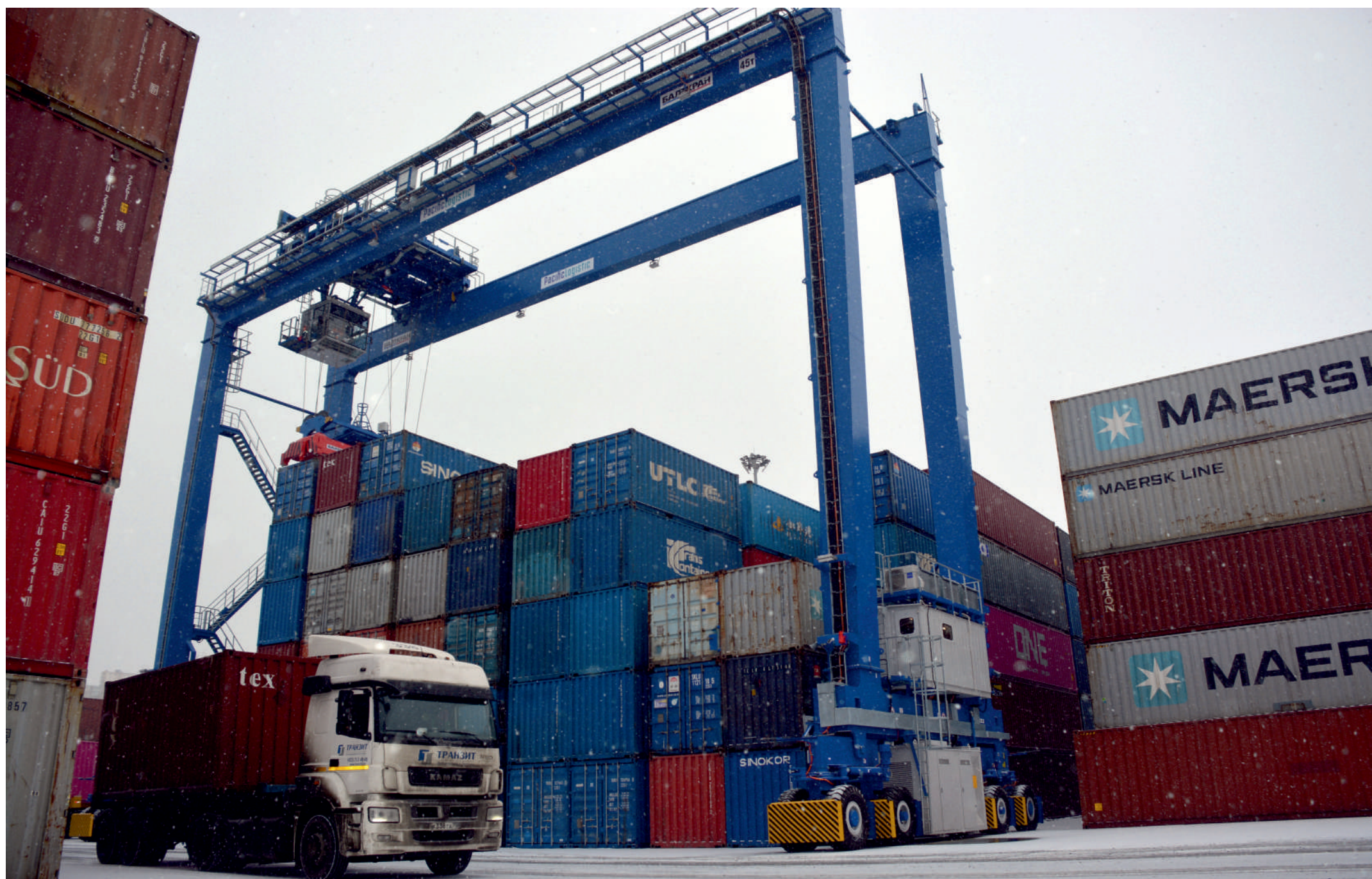
Контейнерный терминал "Пасифик Лоджистик", морской порт г. Владивосток, г/п 45 т., пролет 9+1, высота 6+1
