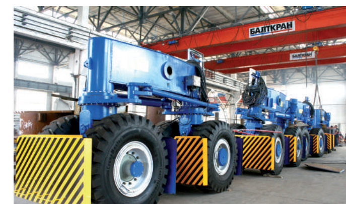
Механическая комплектация, сборка ходовых частей крана RTG
