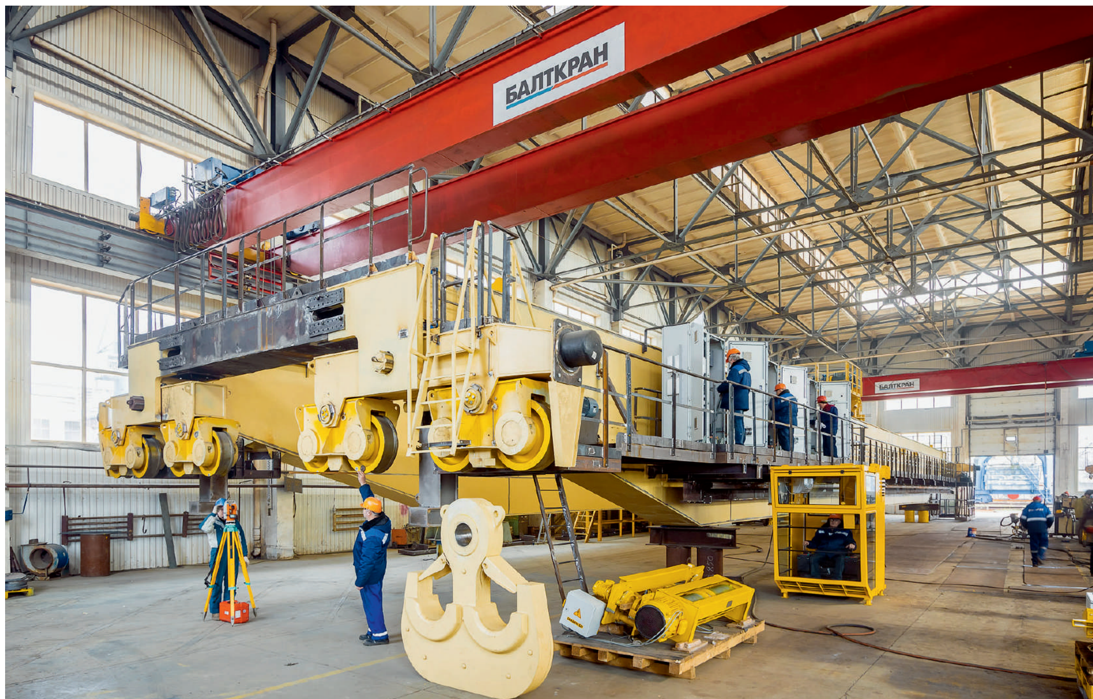
Испытание мостового крана машзала г/п 200 т. для Бангладэш на АЭС Руппур, длина моста 60 м.
