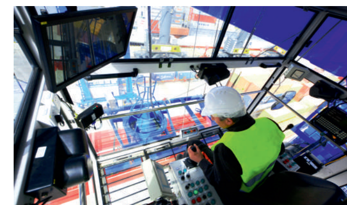
Просторная кабина с отличным круговым обзором, панель системы управления краном и видеомониторингом.
