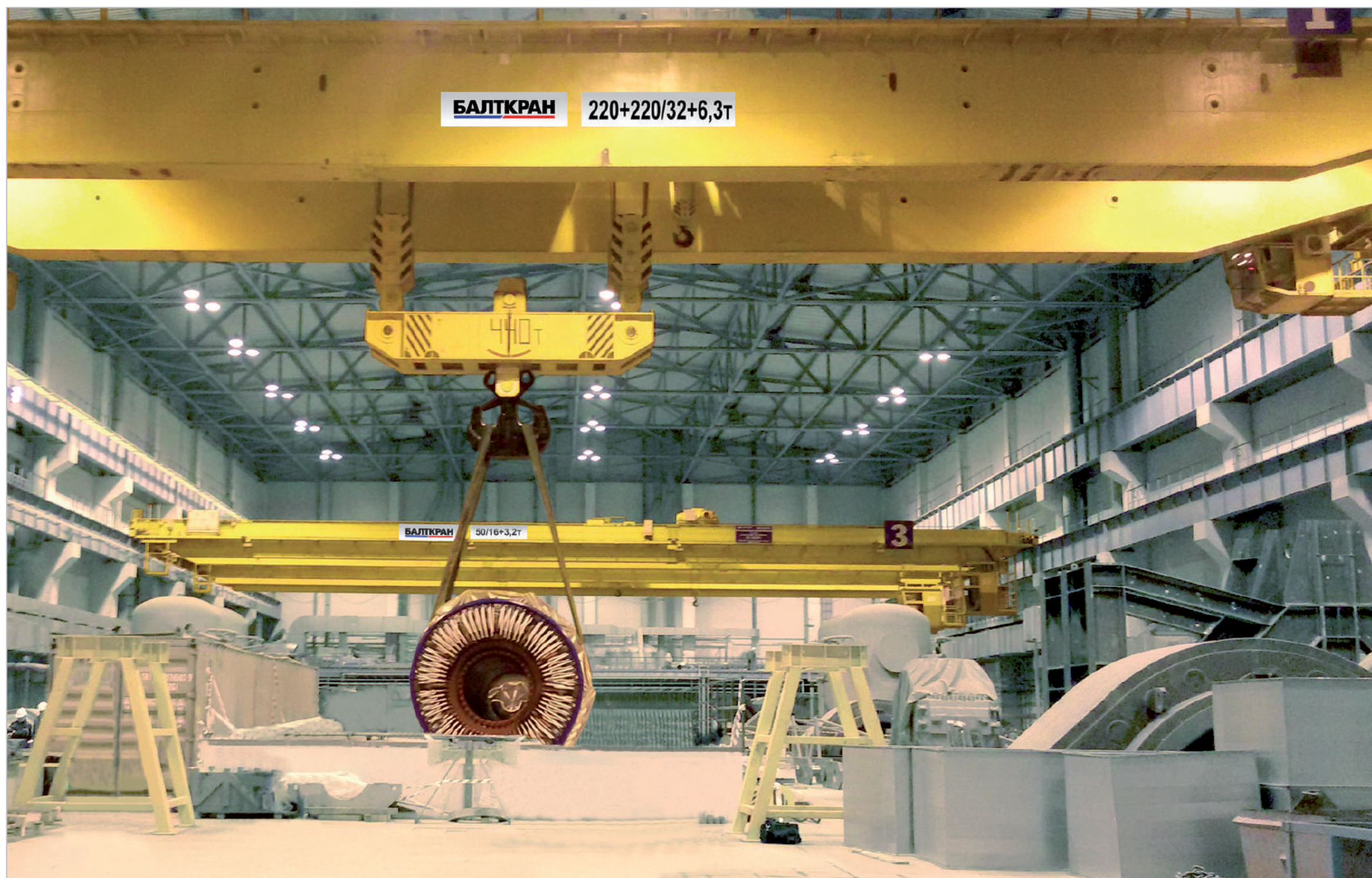
Ленинградская АЭС, мостовой кран машзала г/п 440/32/6,3 т., пролет 44,5 м., высота подъема 32 м.
