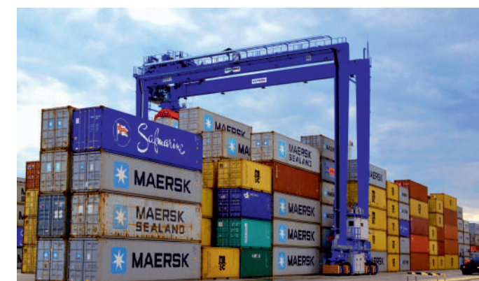
"Балтийская стивидорная компания", морской порт г. Балтийск, кран RTG г/п 41 т., пролет 7+1, высота штабелирования 6+1
