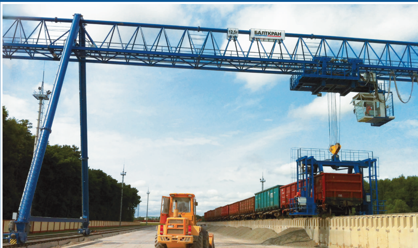
КОЗЛОВЫЙ КРАН для механизированной разгрузки вагонов
