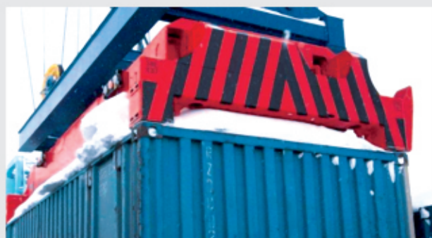
Электрический телескопический спредер для низких температур и глубокого снега
