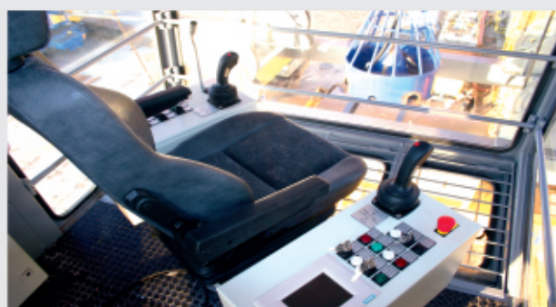
Эргономичная кабина с поворотным пультом и идеальным панорамным обзором
