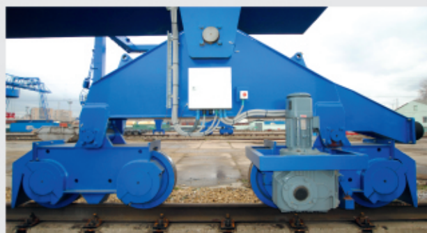
Сбалансированная ходовая часть - меньшая чувствительность к неровностям рельсов и поверхности участка
