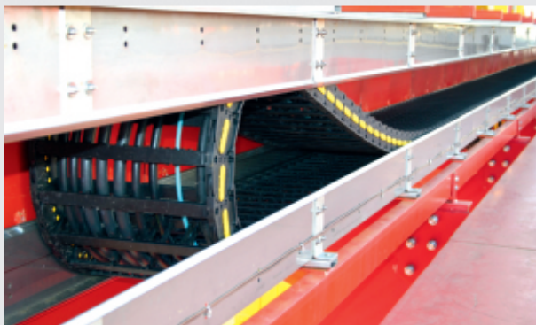
Траковый токоподвод значительно продлевает срок службы кабелей и обеспечивает максимальные скорости
